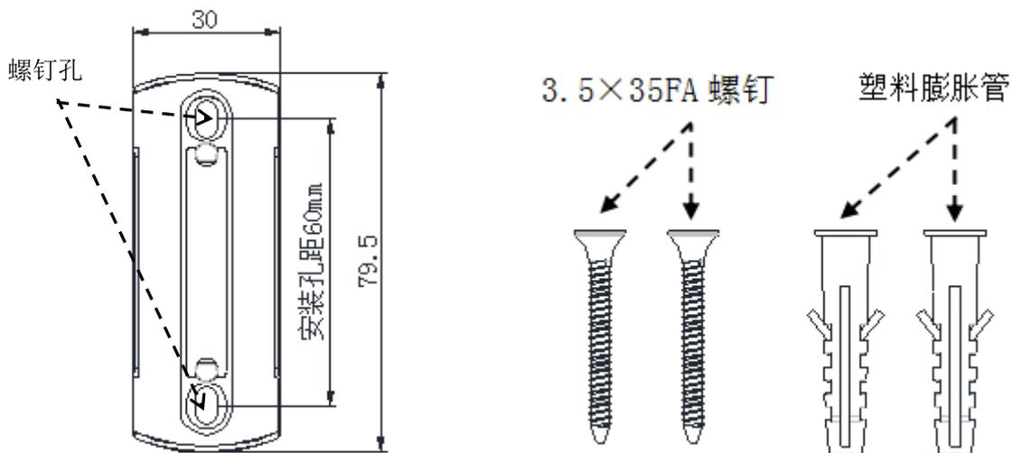
图 2 TX3252A 物联网网关底座及固定配件
