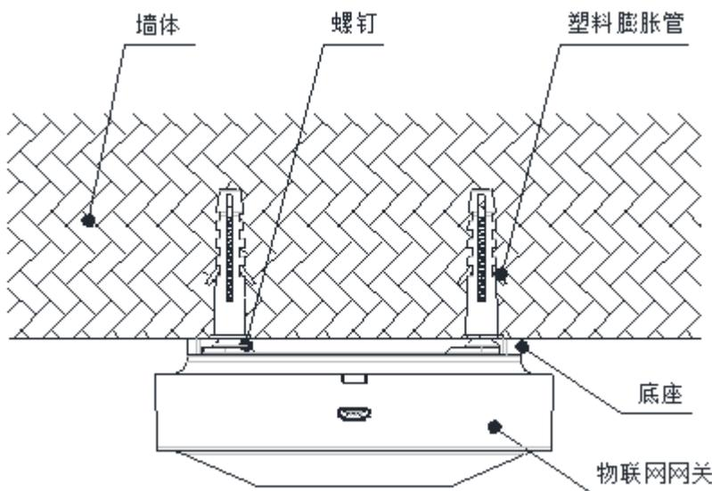
图3 TX3252A 安装示意图
