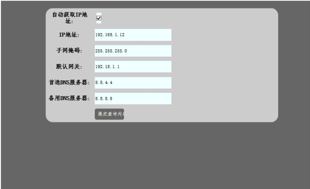
注：配置完成后，拔去配置网线，将模块重新上电。
